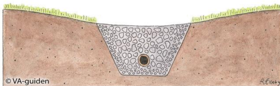
Figur 22. Principritning makadamdike, taget från vaguiden.se.
